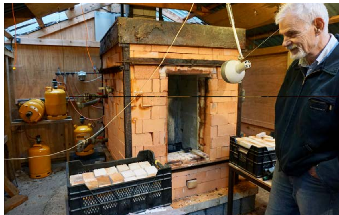
Finn ved sin hjemmebyggede, gasfyrede stentøjsovn
